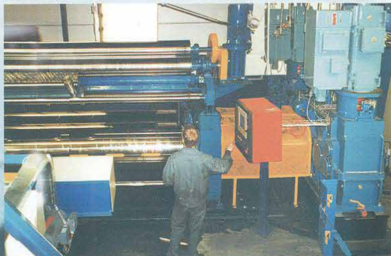
Automatisches Walzwerk mit Schrittsteuerung und 2x200kW-GS-Antrieb in kompakter Vertikal-Bauform
