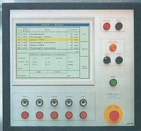
Bedieneinheit mit Touch Panel. Dargestellt: Schrittanzeige
